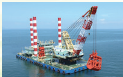
2014年 ハイブリッド式グラブ浚渫船「若鷲丸」完成
