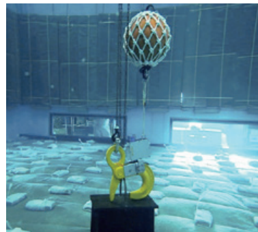
「遠隔玉外し装置」の実験状況
