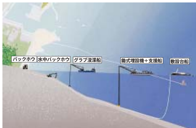
取水管防護工水深別使用機械
