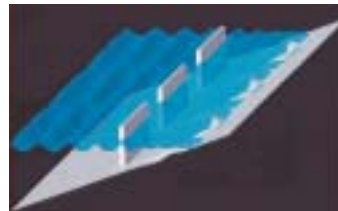
離岸堤背後の海浜変形
