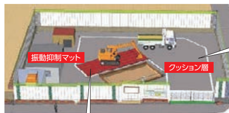
移動する重機の下に、振動抑制マットを設置した。
