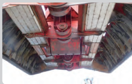
グラブバケット内部に装着した発泡スチロール
