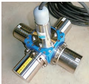
船上トランスデューサー (左:SSBL多素子、右:SBL単素子)
