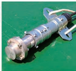
船上トランスデューサー (左:SSBL多素子、右:SBL単素子)
