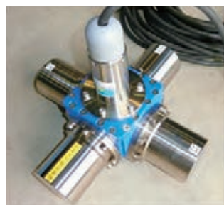
船上海上トランスデューサー (左:SSBL多素子、右:SBL単素子)
