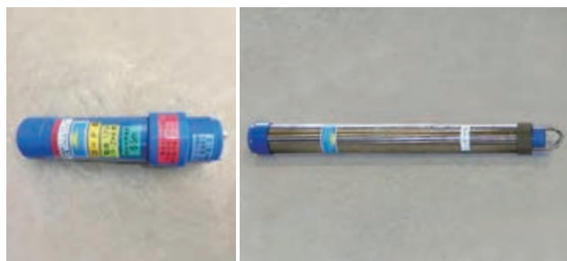
測位対象物用トランスポンダ (左:潜水士用、右:高精度測位用)
