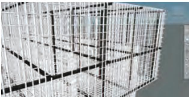
追加工種を配置した3DCAD図による作業性や干渉位置の確認
