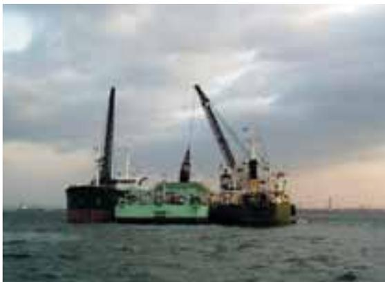
ガット船によるトレミー管への投入
