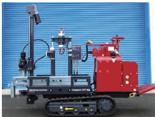
写真-2 専用の自走式貫入機（自社機）
