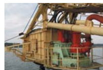
高濃度薄層浚渫船／集泥機
