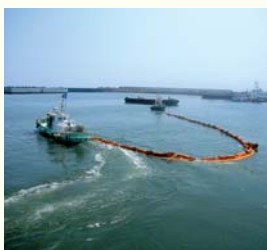
汚濁防止膜展張訓練
