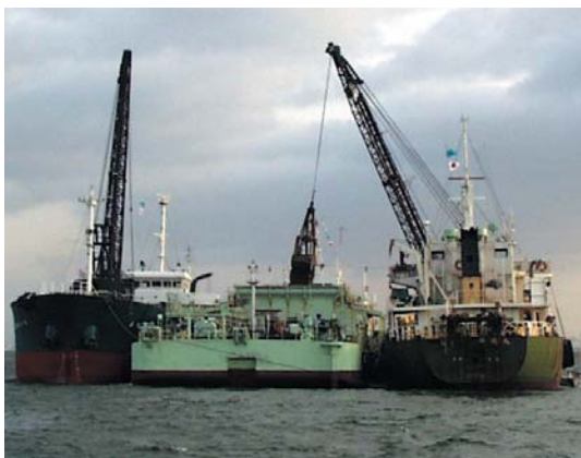
トレー式砂撒き船 (WTS-1000) 施工状況
