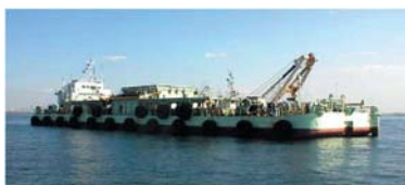
トレー式砂撒き船 WTS-1000
