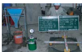
スランブロー試験
