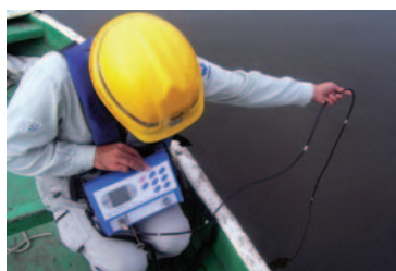
濁度の監視測定
