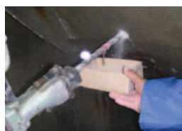
塩化物イオン 測定の試料採取
