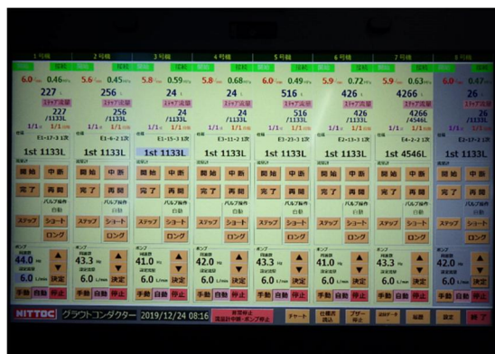
Grout Conductor による注入管理状況
