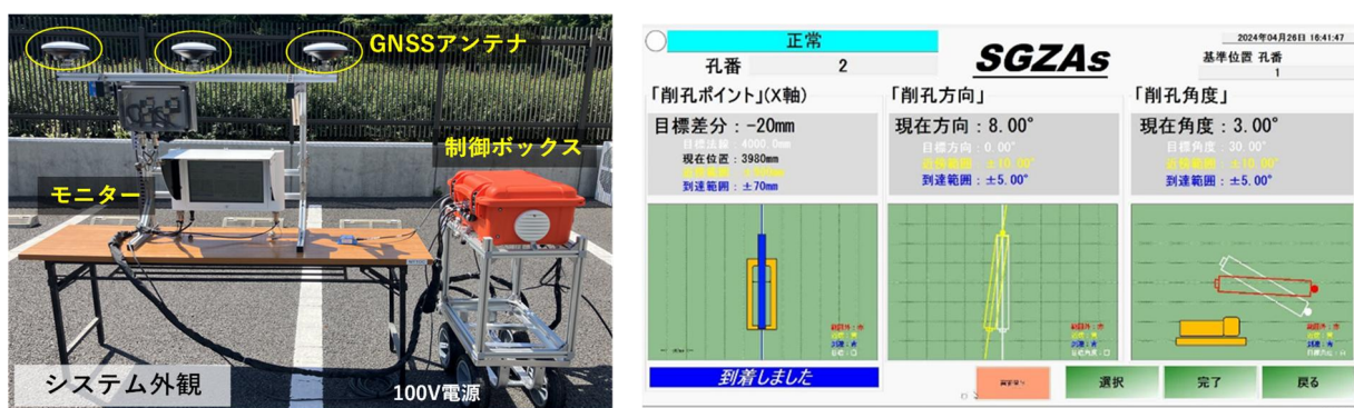
SGZAs の外観とマシンガイダンス時のモニター例
