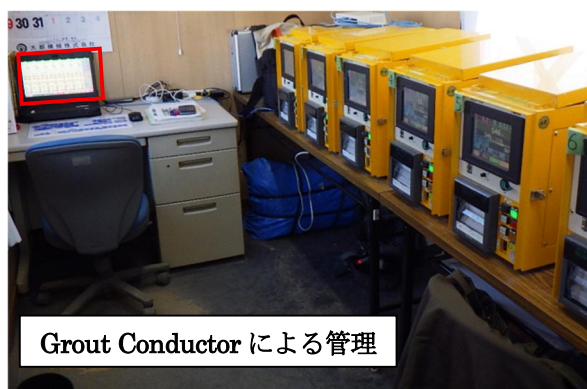
Grout Conductor による注入管理状況
