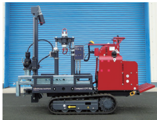
写真-2 専用の自走式貫入機（自社機）
