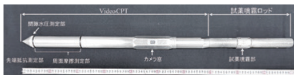
写真-1 「WIT-video-CPT」試験器本体
