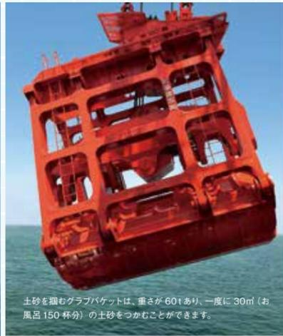
土砂を掴むグラブバケットは、重さが60tあり、一度に30m<sup>3</sup>(お風呂150杯分)の土砂をつかむことができます。
