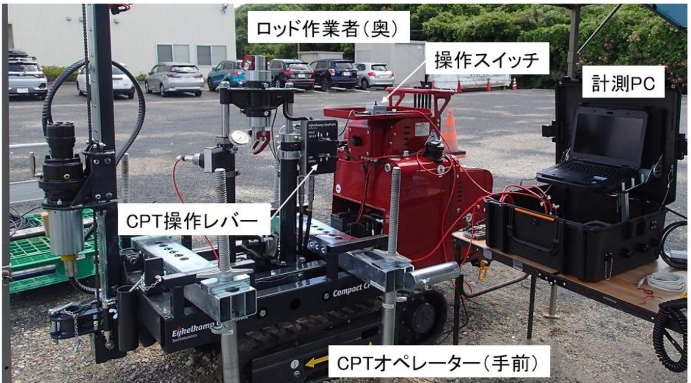
専用自走式貫入装置(Compact CPT-Rig)
