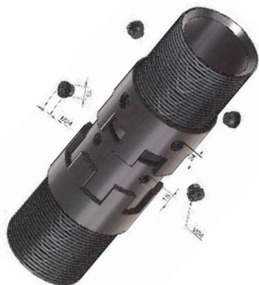
写真-5.3.3 ケーシング分割用の治具（例）
